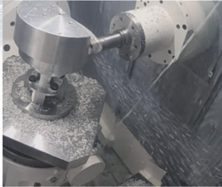
最新工具の能力を十二分に引き出す、高速回転主軸と高速送り軸による高速切り削は、アルミニウムの削り出し加工やニアネットシェイプのアルミダイキャスト、鋳物の加工など高速軽切削で高生産性を実現します。
