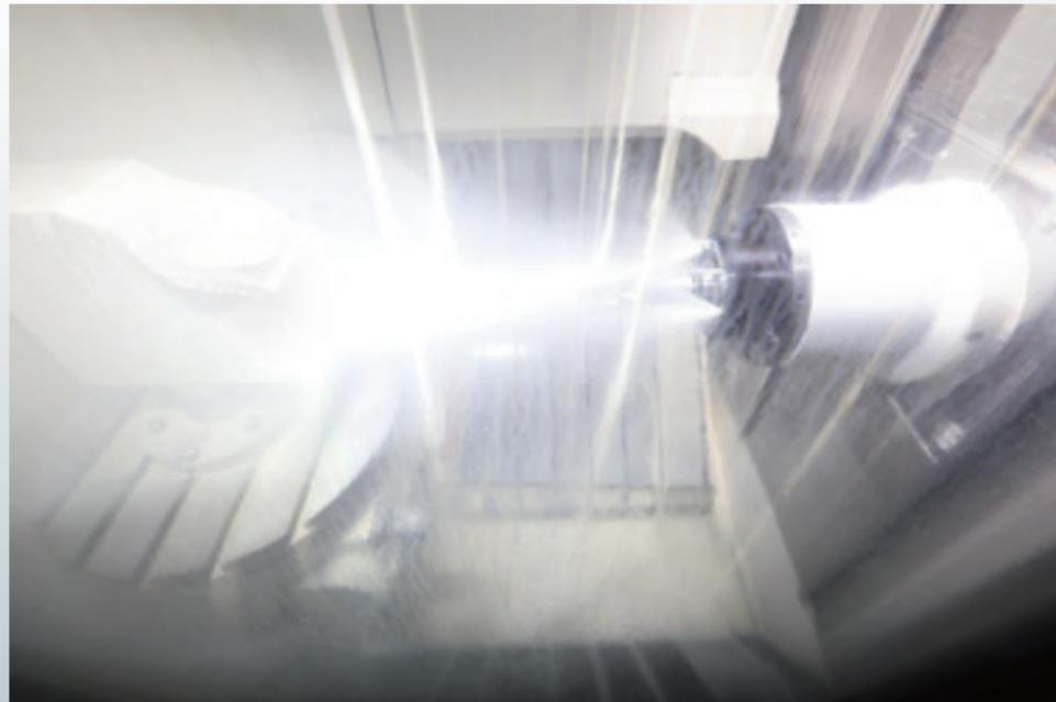
強い水流でテーブル、ワーク上面とワーク内側に堆積した切屑をセンタートラフ内のチップコンベアへ落とし込み大量の切屑を機外へ速やかに排出できます。
