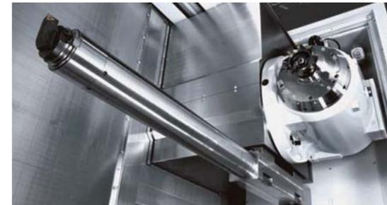
大物部品の内径・深穴加工に便利な、ロングボーリングバー専用ストックをテールストック上部に装備。先端工具は標準工具と同じく、ツールマガジンに収納されます。e-670H・e-800HではATC装置で先端工具の自動交換が可能です。従来の旋盤ではできなかった深穴加工が自動で行えます。
