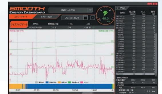
CNC装置のプロセスホーム画面にも消費電力を表示します。
