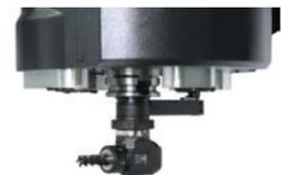
アングルツール最高回転数 5000 min<sup>-1</sup> の高速タイプです。30本および60本ツールマガジンに収納可能です。
