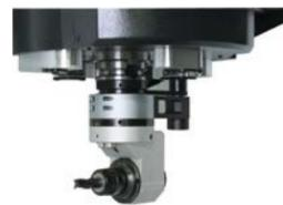
アングルツール最高回転数 3000 min<sup>-1</sup> の標準タイプです。30本および60本ツールマガジンに収納可能です。
