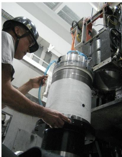
主軸ヘッドの取り付け作業
