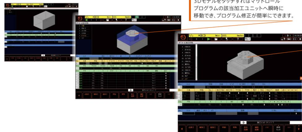
3Dモデルをタッチすればマザトロールプログラムの該当加工ユニットへ瞬時に移動でき、プログラム修正が簡単にできます。
