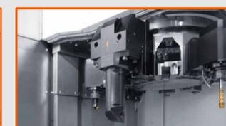
ボーリングツールなどは隣接のマガジンに格納され、必要時に専用ポジションに設けたホルダへ自動交換します。
