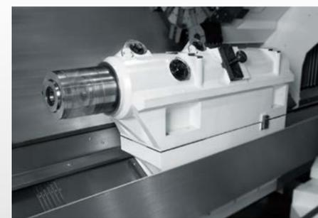
1台の機械で短尺ワークにも対応する2ポジションテール手動クイル
