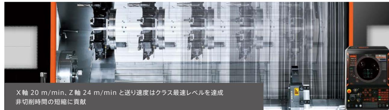
X軸 20 m/min、Z軸 24 m/min と送り速度はクラス最速レベルを達成
