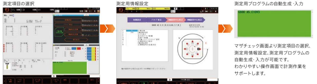
マザチェック画面より測定項目の選択、測定用情報設定、測定用プログラムの自動生成・入力が可能です。わかりやすい操作画面で計測作業をサポートします。
