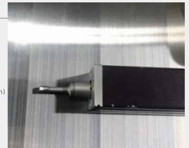
研磨加工面の測定
