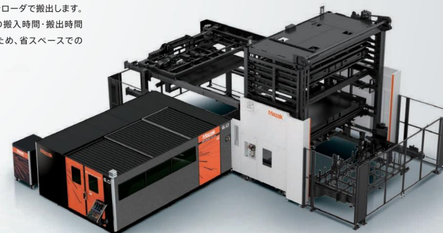
OPTIPLEX 3015 DDL + QUICK CELL 3015 6段ストック
