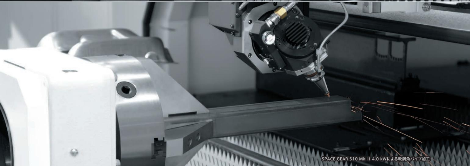
SPACE GEAR 510 Mk II 4.0 kWによる軟銅角パイプ加工
