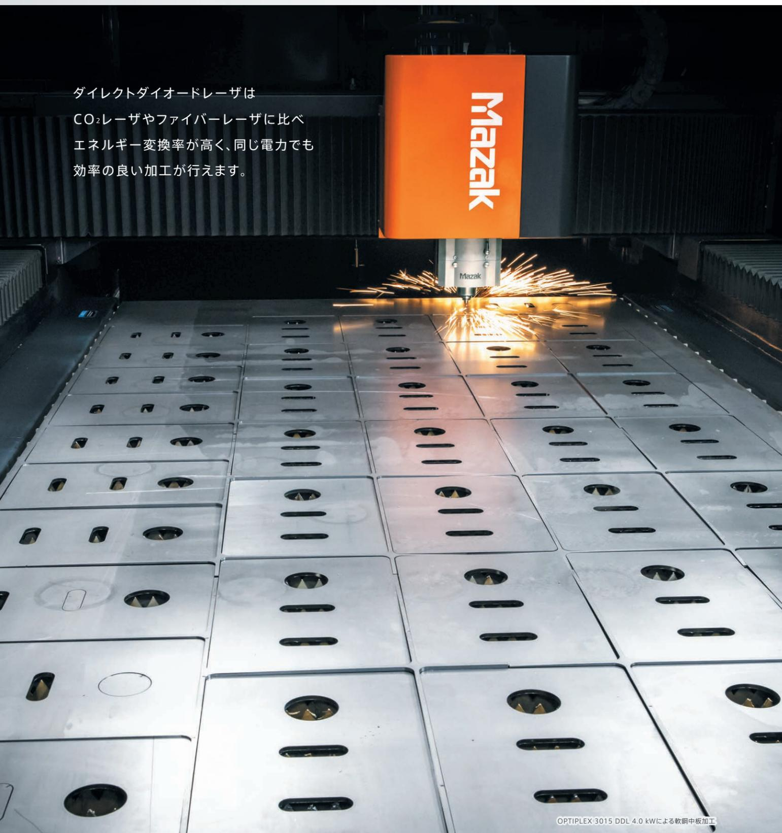
OPTIPLEX 3015 DDL 4.0 kWによる軟鋼中板加工
