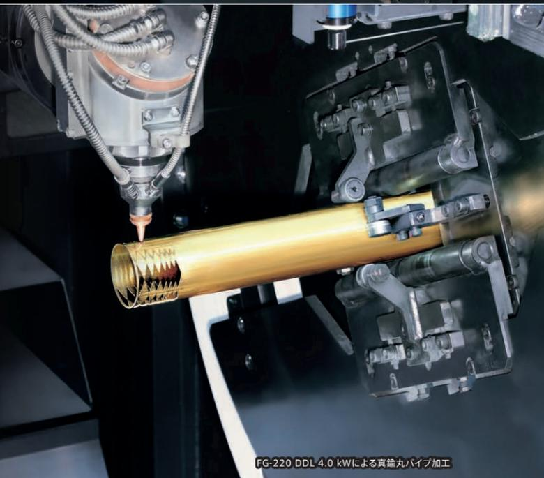
FG-220 DDL 4.0 kWによる真鍮丸パイプ加工
