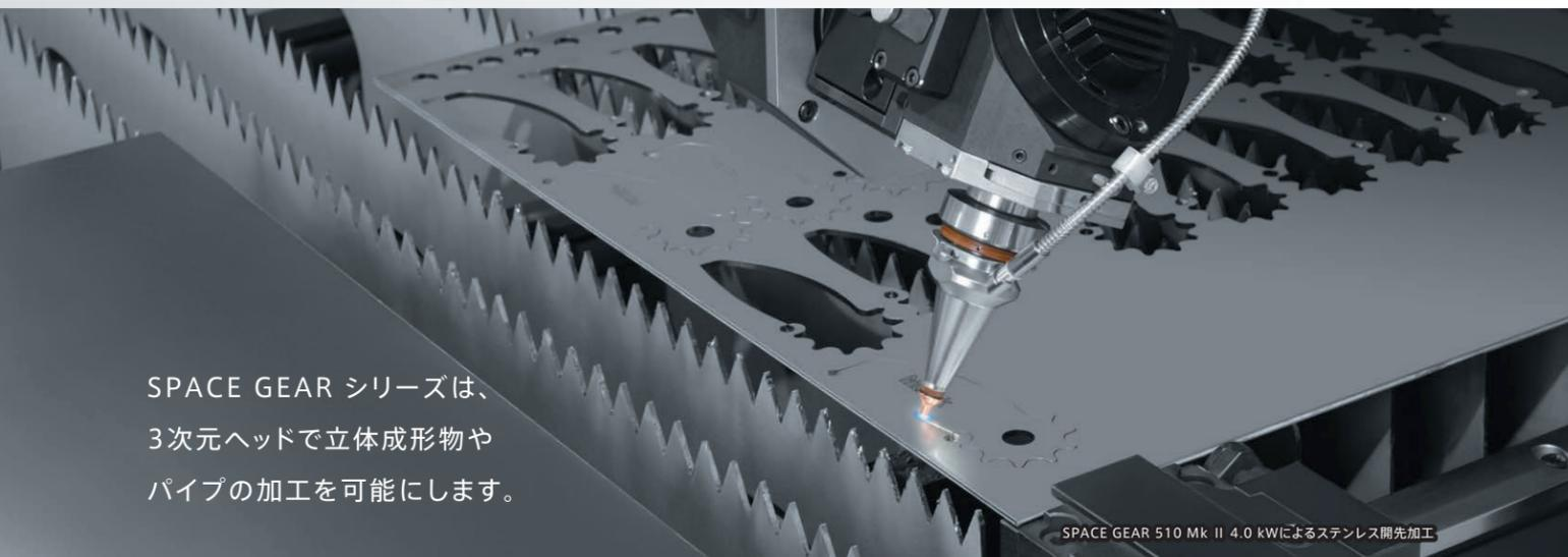
SPACE GEAR 510 Mk II 4.0 kWによるステンレス開先加工
