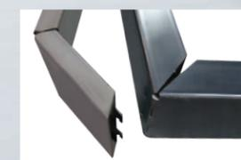
トラクターシャーシーをモチーフとしたアプリケーション。3次元レーザ加工により溶接治具を不要とし溶接工程を簡易化、溶接歪みを軽減できます。
